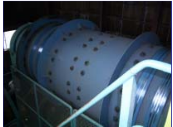
<中沼路盤材リサイクルプラント> ドラムウオッシャ(洗浄機)
