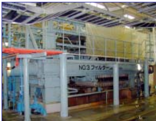
<厚別水再生プラザ汚泥処理施設> フィルタープレス（加圧脱水機）
